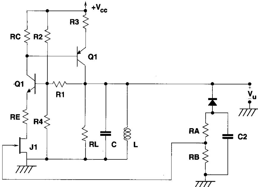
Il circuito è alimentato con  $+V_{CC} = +15 \text{ V}$ ;  $Q_1$  è un BC109B resistivo con  $h_{oe} = 0$ ,  $h_{re} = 0$ ,  $Q_2$  un BC179B resistivo con  $h_{oe} = 0$ ,  $h_{re} = 0$ ,  $J_1$  un F245B resistivo con  $r_d \rightarrow \infty$
