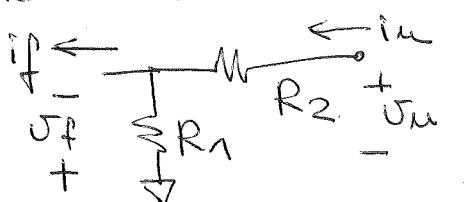
$$\begin{bmatrix} v_f \\ i_u \end{bmatrix} = \begin{bmatrix} \beta & R_{of} \\ \frac{1}{R_{if}} & K \end{bmatrix} \begin{bmatrix} v_u \\ i_f \end{bmatrix}$$
