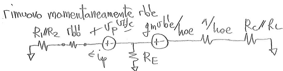
$$i_p = \frac{v_p}{R_1 // R_2 + r_{bb} + R_E // \left[ \frac{1}{h_{oe}} + R_C // R_L \right]} + \frac{g_m v_p}{h_{oe} \cdot \left[ \frac{1}{h_{oe}} + R_C // R_L + R_E // (R_1 // R_2 + r_{bb}) \right]}$$
