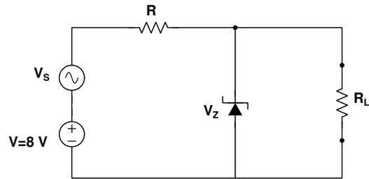
2) Lo stabilizzatore deve poter alimentare un carico massimo (resistenza minima) pari a  $R_L = 50 \Omega$ . Determinare la corrente di polarizzazione ottimale per lo Zener e i parametri del circuito (resistenza  $R$ ). Disegnare inoltre una caratteristica  $I - V$  con la retta di carico.[4]
